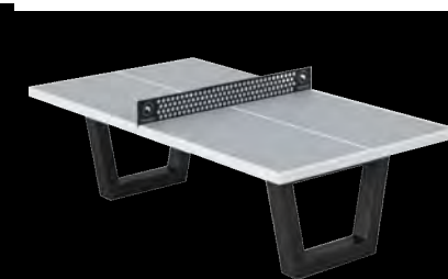
6. Теннисный стол антивандальный 2740 x 1525 x 760 мм Каркас: арматура Бетонная часть: серый портландцемент М500 Наполнитель: гранит фракции 5-10мм
